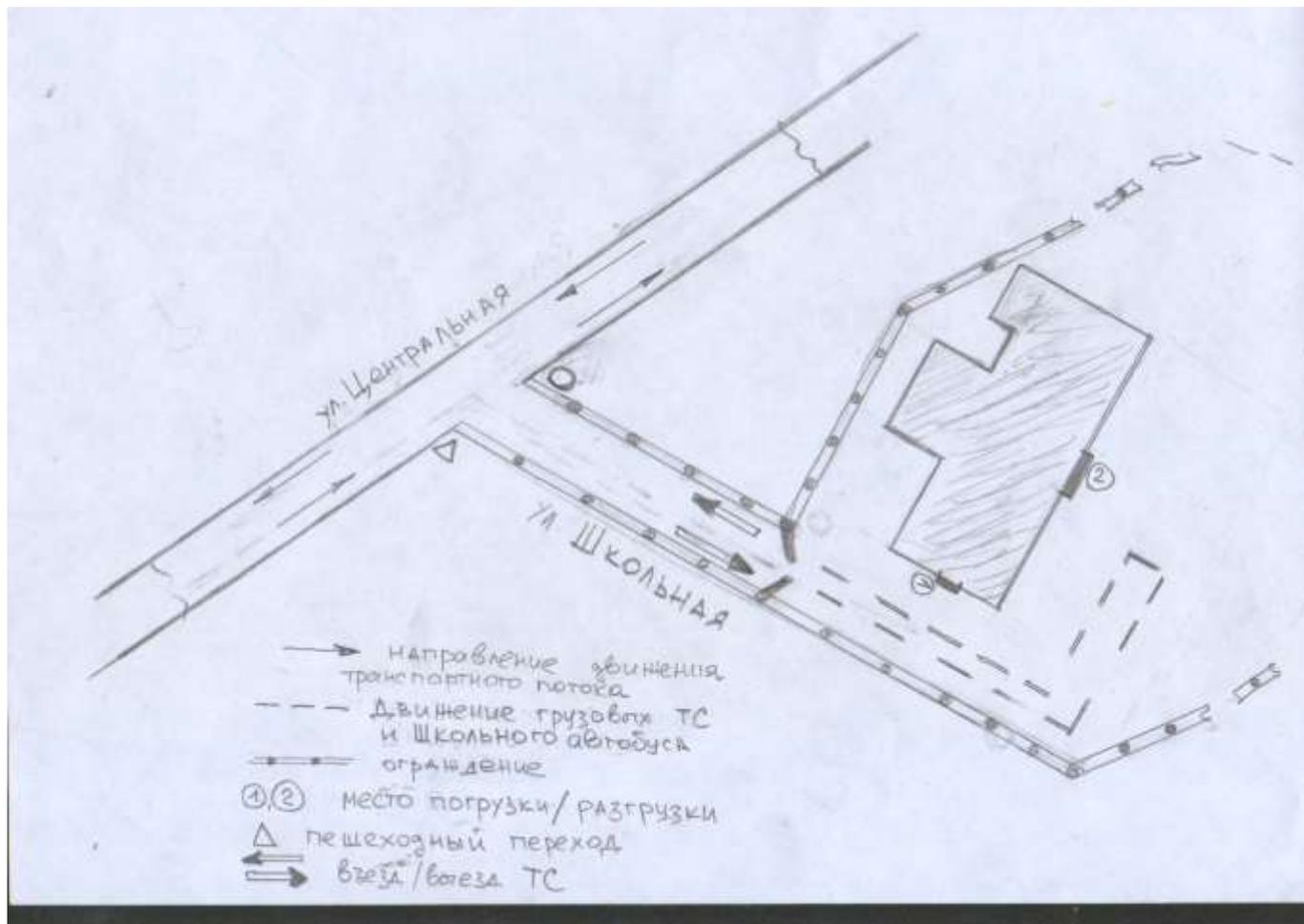
На схеме указана примерная траектория движения транспортного средства на территории ОУ, в том числе место погрузки/разгрузки, а также безопасный маршрут движения детей во время погрузочно-разгрузочных работ.
